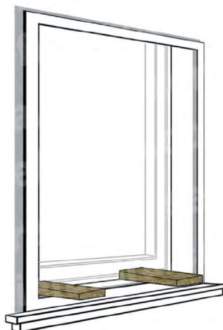
POSIZIONARE SULLA BANCHINA DEGLI SPESSORI DA 50mm A 10mm IN BASE ALL'ALTEZZA DELL'INFERIATA
