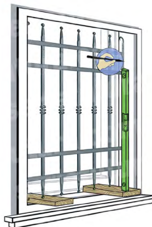
SEGNARE CON UN PENNARELLO LA POSIZIONE CORRETTA OVE ESEGUIRE I FORI
