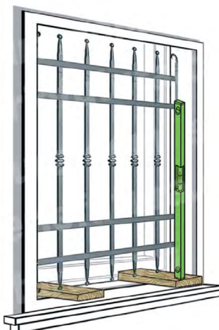
APPOGGIARE L'INFERRIATA SUGLI SPESSORI E CON L'AUSILIO DI UNA LIVELLA METTERLA A BOLLA
